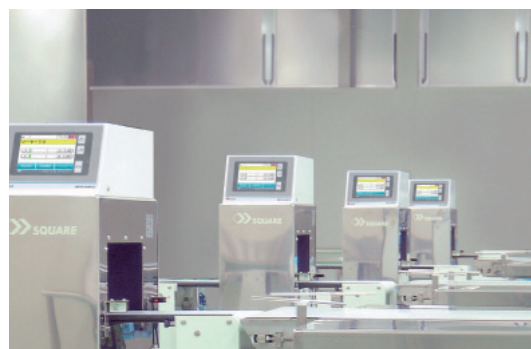
▲食品工場の生産ラインに設置された金属検出機
