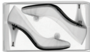
▲X線検針機では釘の深さやヒールのピンの長さが簡単にチェックできる
